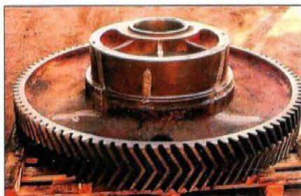
Soudure excentrique de presse à emboutir.
