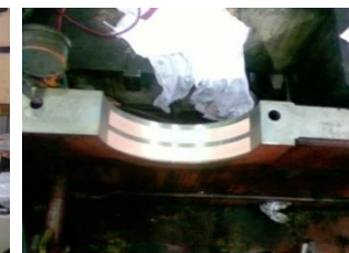
ELECTROLYSE AU TAMPON : sur vérins hydrauliques, cylindres d'imprimerie, portées de roulements, alternateurs, etc.
