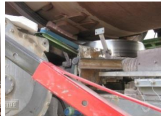
RECTIFICATION : de bandages et de galets sur tubes tournants
