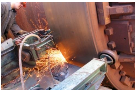
USINAGE, RECTIFICATION, POLISSAGE : sur tous types de cylindres. Longueur 1000 à 5500 mm
