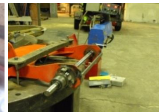
ALESAGE : sur site avec plusieurs types machines de diamètre 40 à 1000 mm
