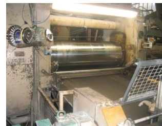
USINAGE, RECTIFICATION, POLISSAGE : sur tous types de cylindres. Longueur 1000 à 5500 mm
